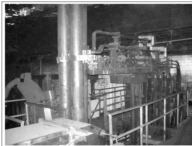
Рис. 2. Агрегат комплексной обработки стали в ковше вместимостью 15 т с тремя электродами на общем кронштейне
